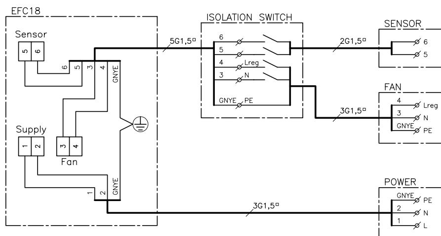
Sluit de EFC18 aan op de temperatuursensor volgens onderstaand schema (RSHT).
