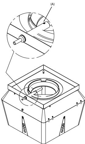
En utilisant une bride FRx-AFD: Enlevez le bouchon et entrez le détecteur de température. Serrez le vis de fixation (A).
