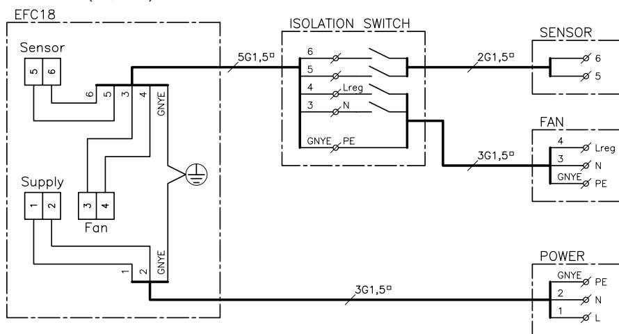
Brancher le EFC18 et le capteur de température, comme indiqué sur le diagramme ci-dessous (RSHT)
