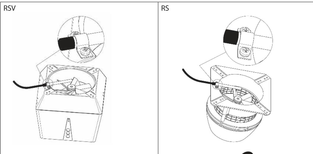
Wenn Sie ein FRx-AFD Abdeckung verwenden, bitte den Stopfen von der Tauchhülse entfernen und Temperaturfühler einführen. Mit der Schraube fixieren (A).
