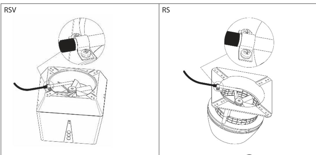
Om en motfläns FRx-AFD används: Ta bort pluggen från röret, och montera in tempgivaren i röret: Dra åt skruven (A).
