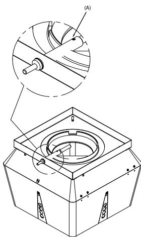
Om en motfläns FRx-AFD används: Ta bort pluggen från röret, och montera in tempgivaren i röret: Dra åt skruven (A).
