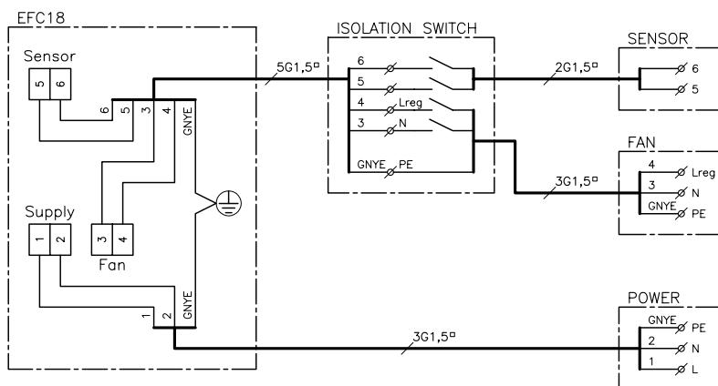
Die Automatik EFC18 und den Temperaturfühler nach dem folgenden Diagramm anschließen (RSHT).
