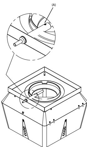
Hvis der bruges en FRx-AFD flange: Fjern proppen fra røret, og indsæt sensoren. Stram skruen (A).
