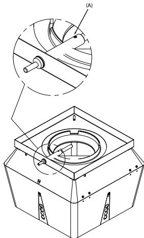
Wenn Sie ein FRx-AFD Abdeckung verwenden, bitte den Stopfen von der Tauchhülse entfernen und Temperaturfühler einführen. Mit der Schraube fixieren (A).
