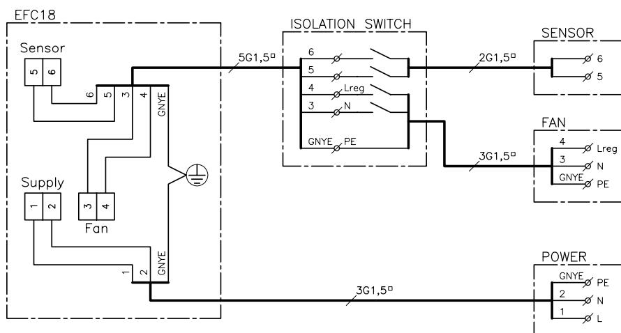
Tilkobl EFC18 og temperaturføler etter diagrammet under (RSHT).
